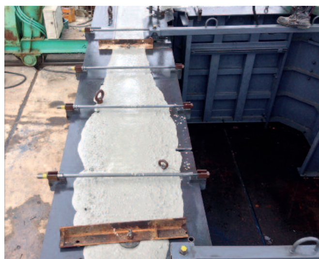
На Рис. 1 и 2 изображена формы для производства водопропускной трубы прямоугольного сечения весом 12,3 т
