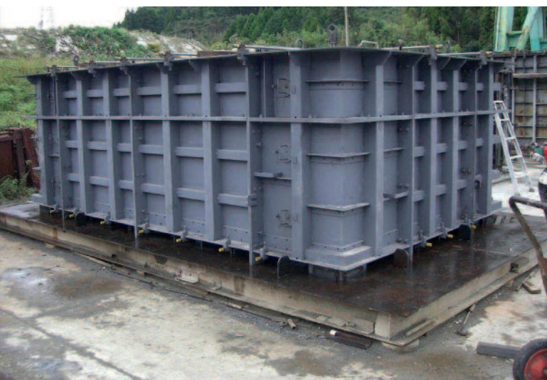
На Рис. 1 и 2 изображена формы для производства водопропускной трубы прямоугольного сечения весом 12,3 т
